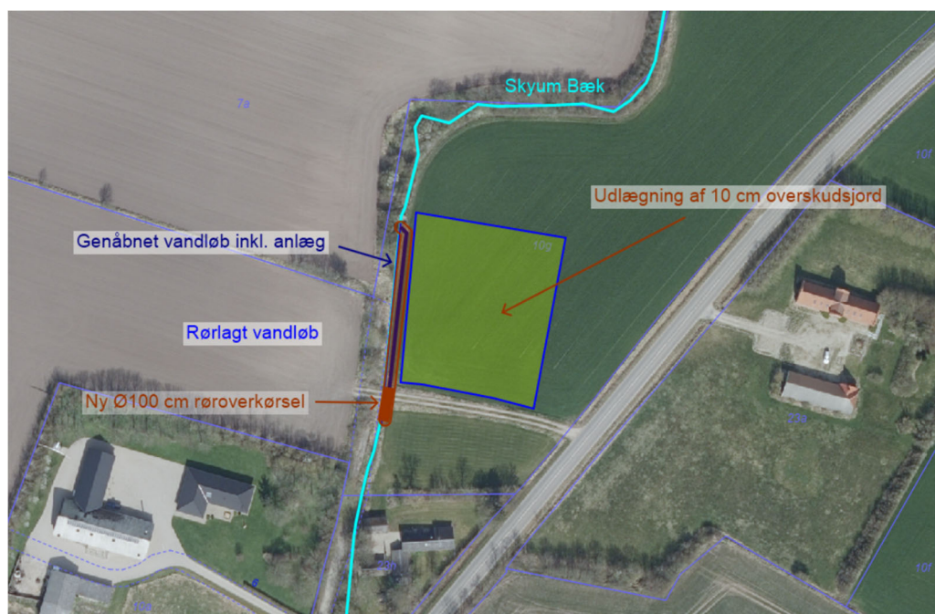
Udlægning af overskudsjord.
